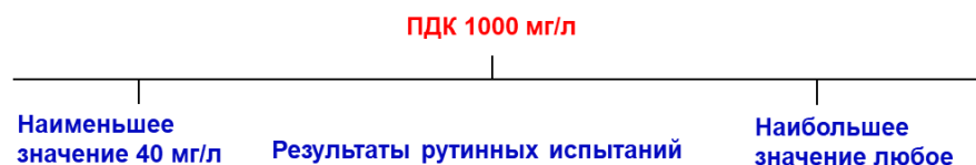
в) Определение сульфатов в сточных водах на очистных сооружениях
